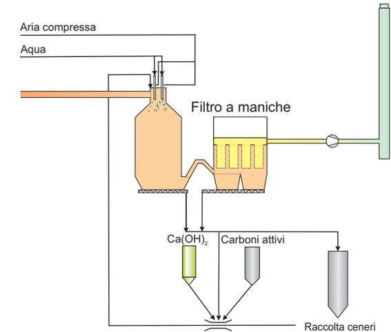
**Tecnologia a umido combinata** per una riduzione massima delle emissioni, minima richiesta di materiale di produzione e
