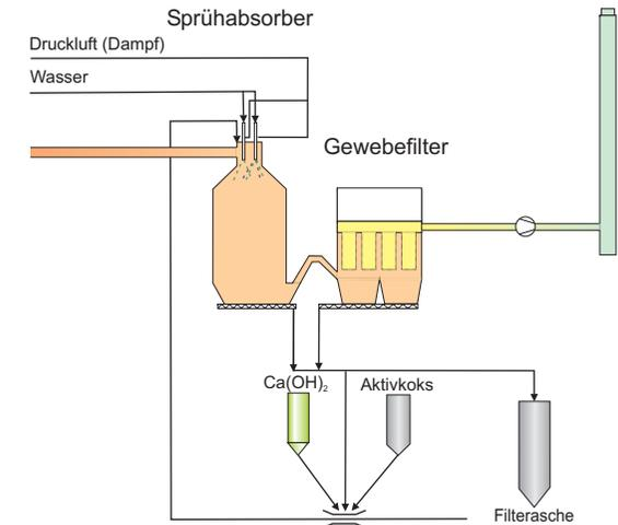
**Kombinierte Nassverfahren** für höchste Emissionsminderung, geringen Betriebsmittelbedarf und optimierte Rückstände
